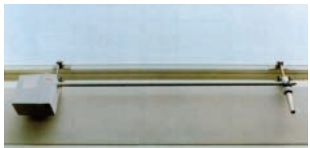
KLEENLUX Lichtkuppelenelement mit elektrischem Spindeltrieb in schlagfestem Gehäuse, Tandemausführung mit Verbindungswelle und mechanischem Nebenantrieb, für Lichtkuppeln ab 150 cm Seitenlänge. Bis zu 6 Spindeltriebe können über einen Schalter gemeinsam bedient werden.
