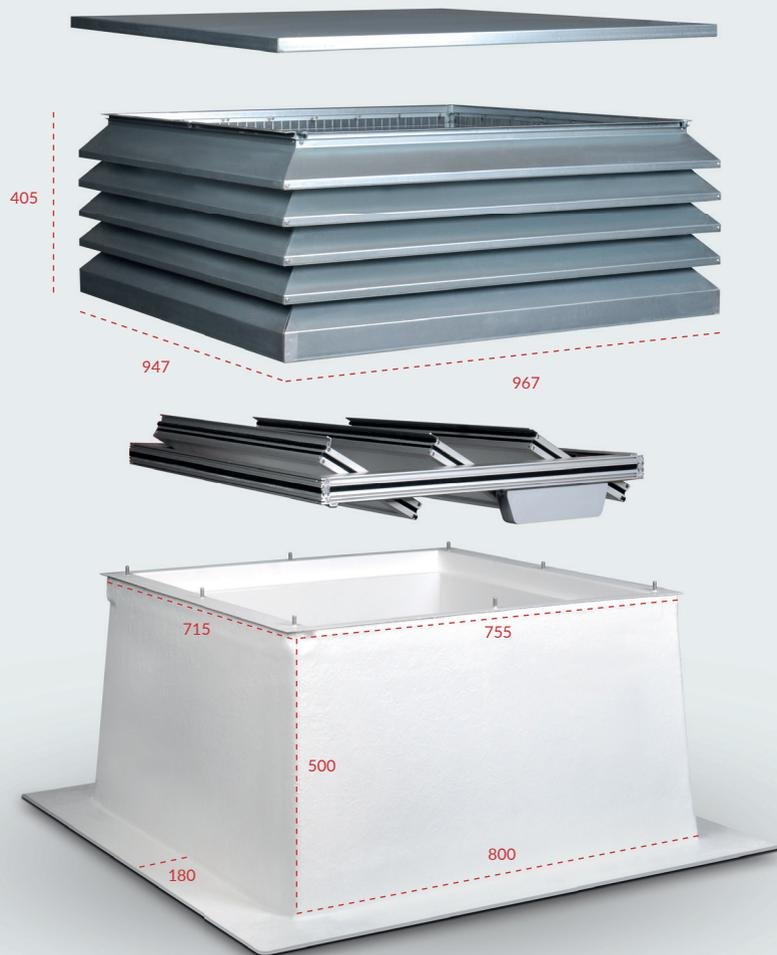
Innovative Neuentwicklung speziell für die wetterunabhängige Lüftung und Entrauchung von Aufzugsschächten, aber auch als Alternative zu üblichen Dauerlüftungsöffnungen. Montage und Eindichtung im Flachdach so einfach wie bei Lichtkuppelenelementen.
